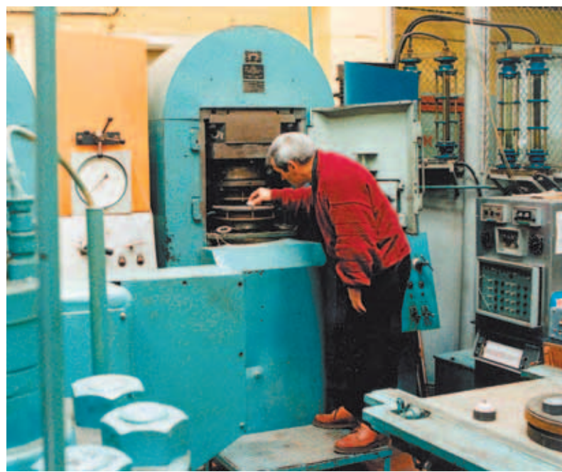
Доктор химических наук Ю.А. Литвин занят постановкой эксперимента по синтезу алмаза на установке высокого давления
