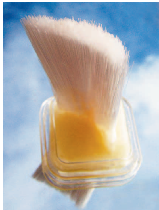
Рис. 2. Пучок сапфировых волокон, полученных методом внутренней кристаллизации
