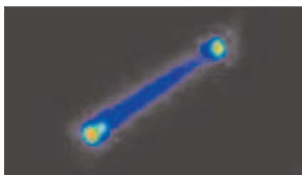
Рис. 3. Лазерная генерация одиночного наностержня оксида цинка с металлическими зеркалами на торцах, наблюдаемая в оптическом микроскопе
